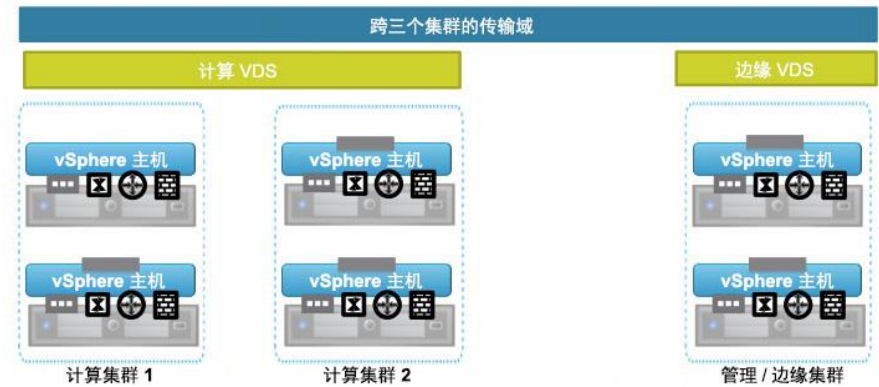
图 15 - 跨越 VDS 和 ESXi 集群的传输域
