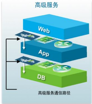
图 57 - 通过第三方供应商提供的高级服务实现的网络分段。
